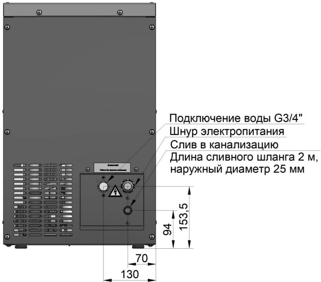
Рис. 5 Схема подключения льдогенератора
