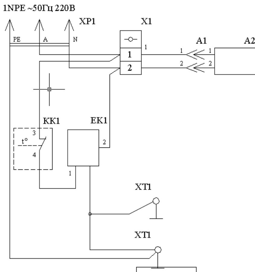
***Металлические части изделия, на которые установлены электрические аппараты, не имеющие собственного заземляющего зажима, или провода с напряжением более 50В, должны иметь надежный электрический контакт с заземляющим зажимом XT1.***
